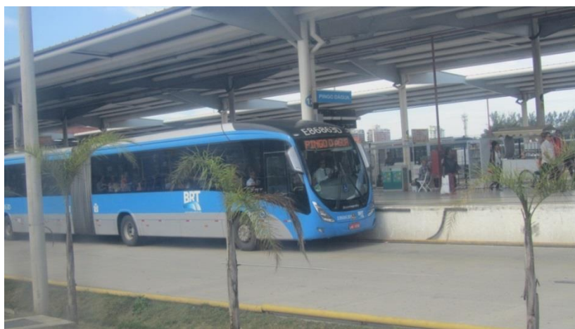
Figur 42 Ledbuss med dörrar på vänster sida för att medge mittplattformar i högertrafik. (Rio de Janeiro)
